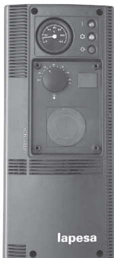
Schaltfeld 'K' / 'KP1' Das Schaltfeld 'K' bzw. 'KP1' wird bei Nachrüstung eines Elektroheizstabes (Speichertypen GX-...-D·A) benötigt. Es verfügt über Speicherthermometer, -thermostat + STB, Schalter Sommer-Winter, sowie Kontrollleuchten. Die Ausführung 'KP1' hat außerdem eine Analog-Zeitschaltuhr. Die Schaltfelder werden in einem Karton verpackt geliefert. Eine Montageanleitung liegt bei.
