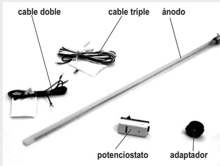
Los modelos MVV-... fabricados en acero vitrificado se suministran con un equipo de protección catódica permanente Lapesa Correx-up, para montar en las instalaciones de nuestros depósitos. Así mismo los modelos MXV-... fabricados en acero inoxidable pueden incorporar equipo de protección catódica permanente específica para depósitos inoxidables "Lapesa Correx-up INOX", para casos de aguas especialmente agresivas o con contenidos en cloruros superiores a 150 mg/l.
